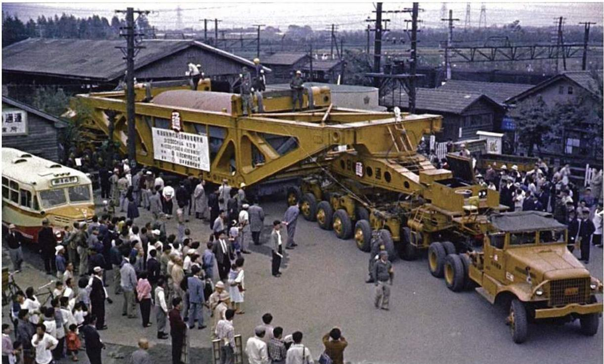
映画「300トントレーラ」※(1960年/制作：運輸新聞映画部)より。横浜線橋本駅から17km離れた変電所へ重量207トンのトランス(変圧器)を運ぶ300トントレーラ。日本初の超重量トレーラで、当時は世界一力持ちのトレーラといわれた。高度経済成長にともなう電力需要の増加に応えるため、各地で電力施設の建設が進んだことが、こうした超重量トレーラを登場させた。
