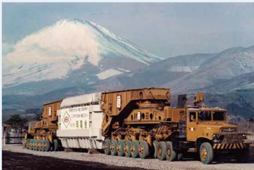
変圧器を輸送する500トントレーラー（250トン型） 年代不明
