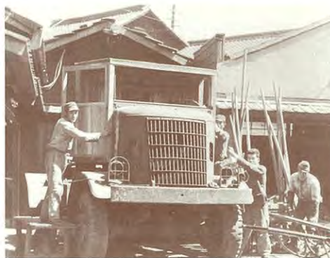
米軍軍下げのトラック 運転台は手作りの木造。1940年代後半
